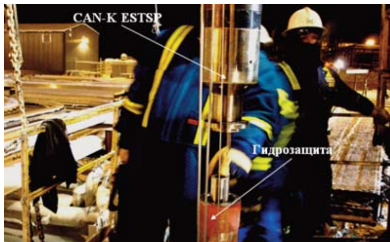
Монтаж погружного двухвинтового насоса с ПЭД
